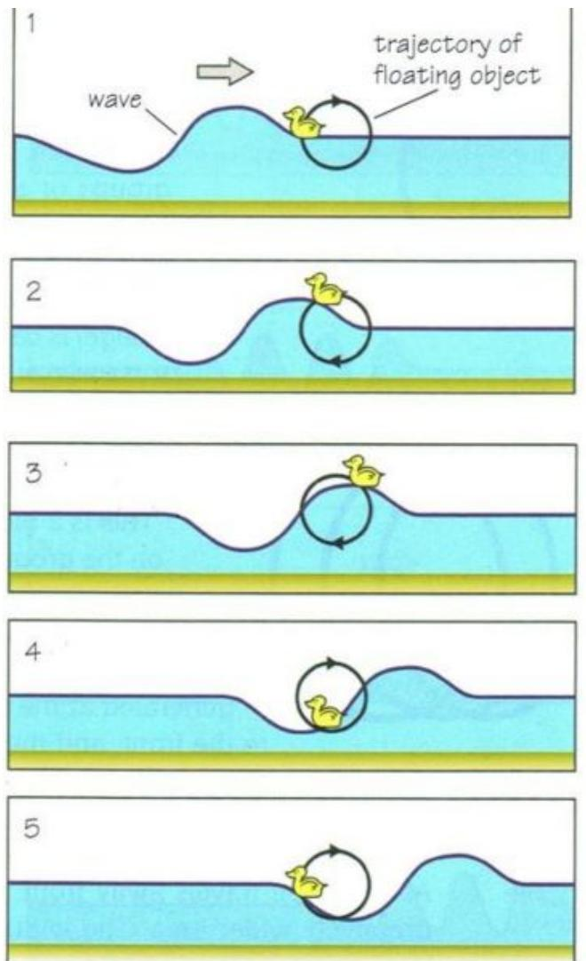
Mouvement d'un objet à la surface de la mer agitée par la houle
