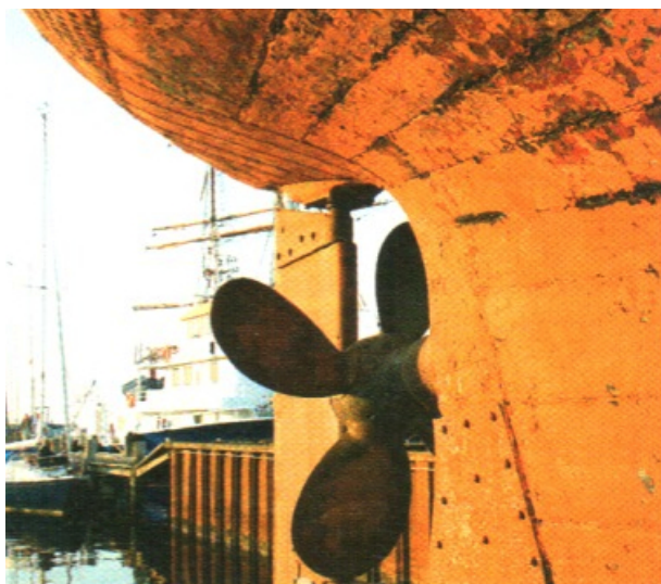
Coque d'un bateau corrodée
