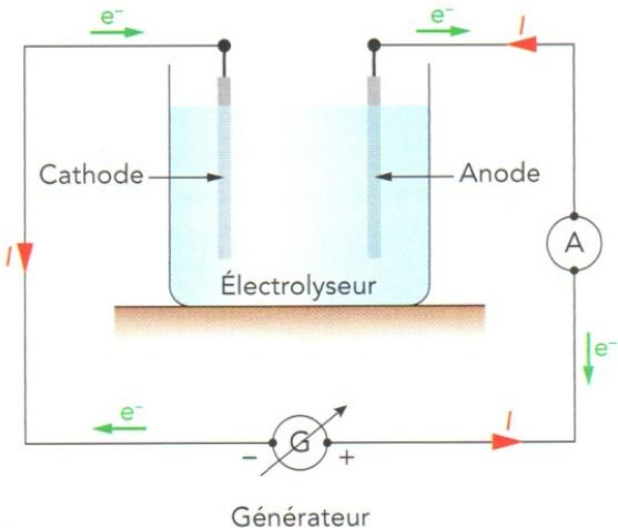
**DOCUMENT II : CHARGE ÉLECTRIQUE MISE EN JEU AU COURS D'UNE ÉLECTROLYSE**
